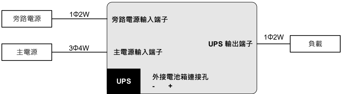
(圖 7-7 : UPS 配線圖_ 雙迴路三相輸入 & 單相輸出)
