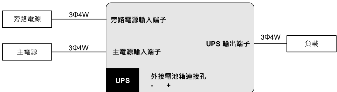
(圖 7-11：UPS 配線圖_ 雙迴路三相輸入 & 三相輸出)
